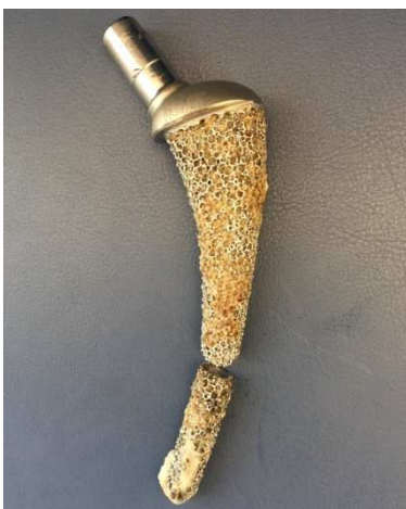
Ermüdungsbruch der Endoprothese nach langer Standzeit
